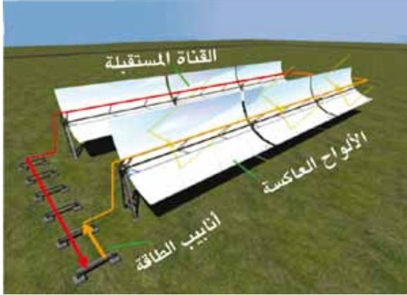
استخدمت الطاقة الشمسية لتوليد الكهرباء؛ حيث تُستعمل مرايا على شكل قطوع مكافئة، تعمل على تسخين زيت يمر خلال أنابيب مارة بيور هذه القطوع.
